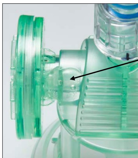
接着剤が表面に見えている状態の一例
